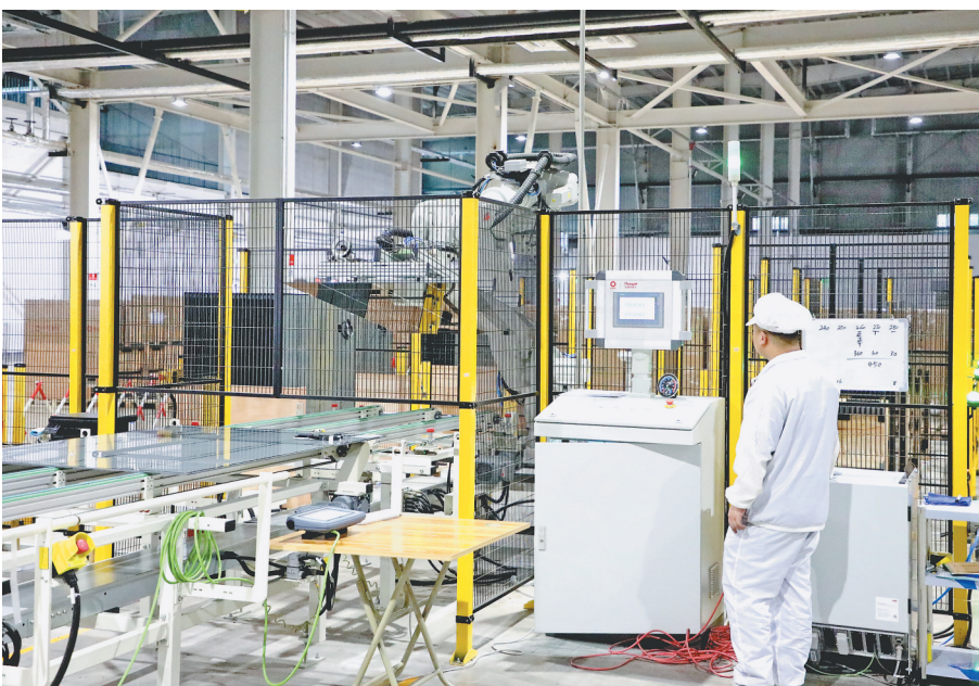
自动下料机器人,通过数据读取,将不同档位的产品自动放入不同箱体进行包装。
