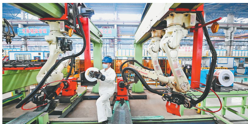
行业首套吊挂管智能制造生产线更换焊丝。
