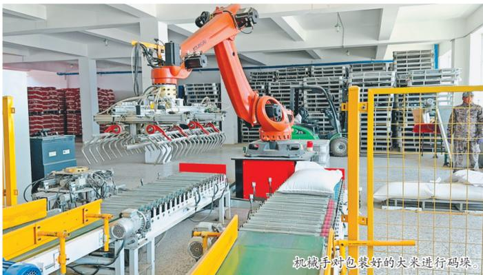
机械手对包装好的大米进行码垛。
