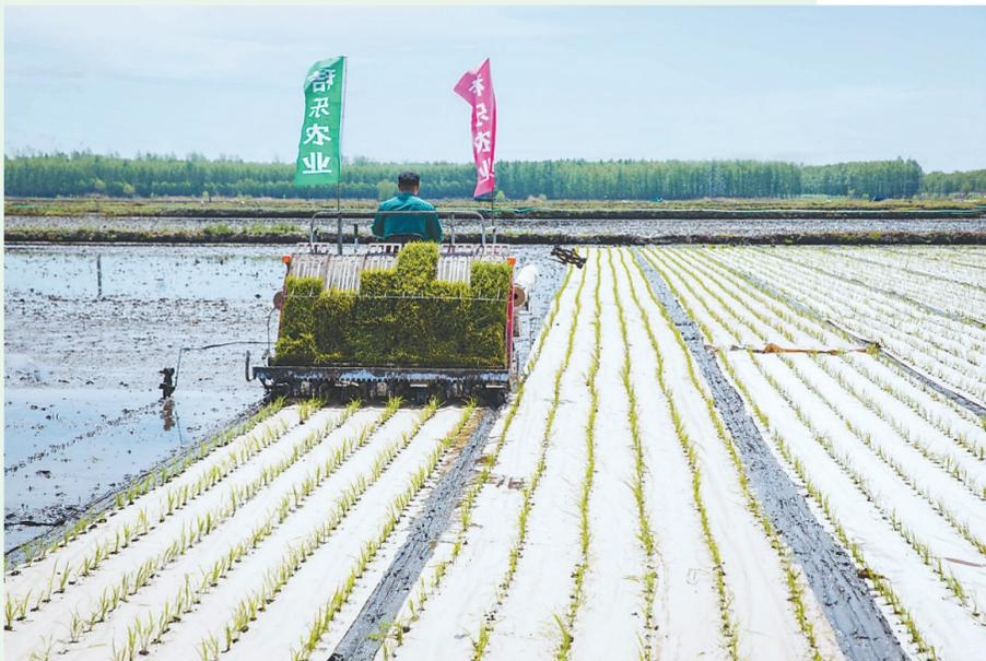
秸秆纤维地膜安装在插秧机上,插秧与覆膜同时进行。 本报记者 梁金池摄
