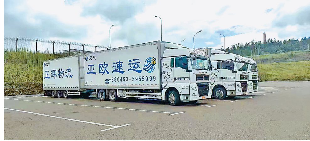
中置轴双挂厢式货车。 图片由受访单位提供
