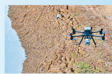
高志市、牡丹江市、武汉市等地的实地技术验证,于2024年推出了AR10智慧巡防系统。该系统集成了高分辨率红外传感器,测级激光雷达、高分辨可见光相机以及智能管涌识别算法,确保了巡堤作业的高效性、精准性和安全性。
