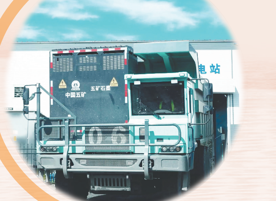
纯电动矿卡换电站。
