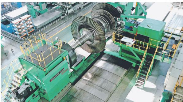
本报讯(马文博 路久宽 记者孙昊)23个月的科技攻坚,加工精度达到头发丝直径的十分之一……近日,我国首台拥有自主知识产权、能够满足汽轮机转子核心零件高精加工的重型数控卧式车床,在齐重数控装备股份有限公司成功问世。该产品在关键核心技术实现新突破,打破了国外对于高端装备的“卡脖子”问题,使汽轮机转子核心加工设备国产化。
