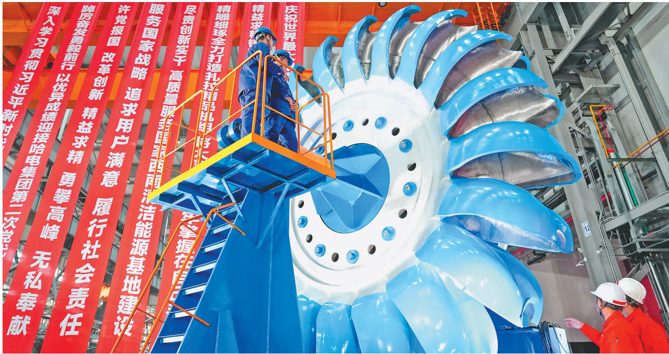
日前,世界最大单机容量、最大尺寸冲击式水轮机转轮在哈电集团焊接制造成功。
