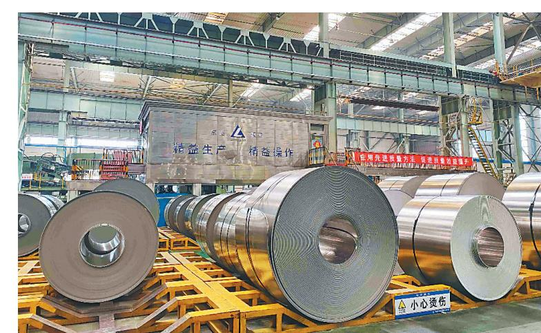
完成冷轧工序的多层铝合金复合板。
