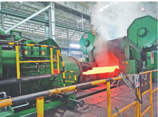
建龙北满特钢特冶锻造厂锻造作业区精锻机正在锻造钢坯。 本报记者 吴玉玺摄
