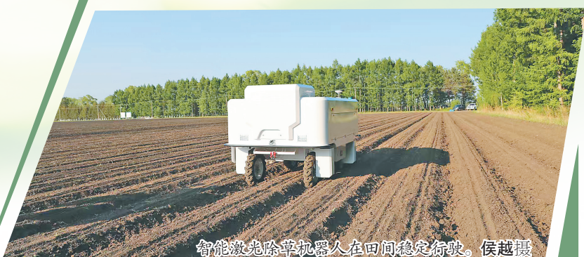
智能激光除草机器人在田间稳定行驶。侯越摄
