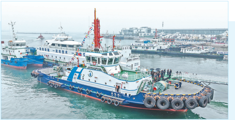
“电拖1”轮靠泊在山东港口青岛港码头。6月26日,国内首艘氢电拖轮——“电拖1”轮在山东港口青岛港入列。该拖轮搭载“氢燃料电池+液冷锂电池”混动系统,可实现零碳排放。 新华社记者 李紫恒摄
