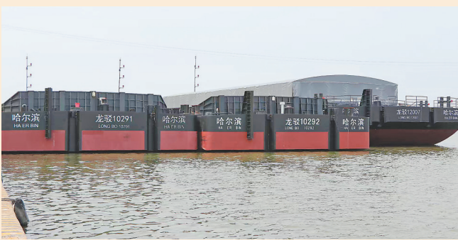
哈尔滨北方船舶工业有限公司建造驳船,船型为1500吨半分节甲板驳。
