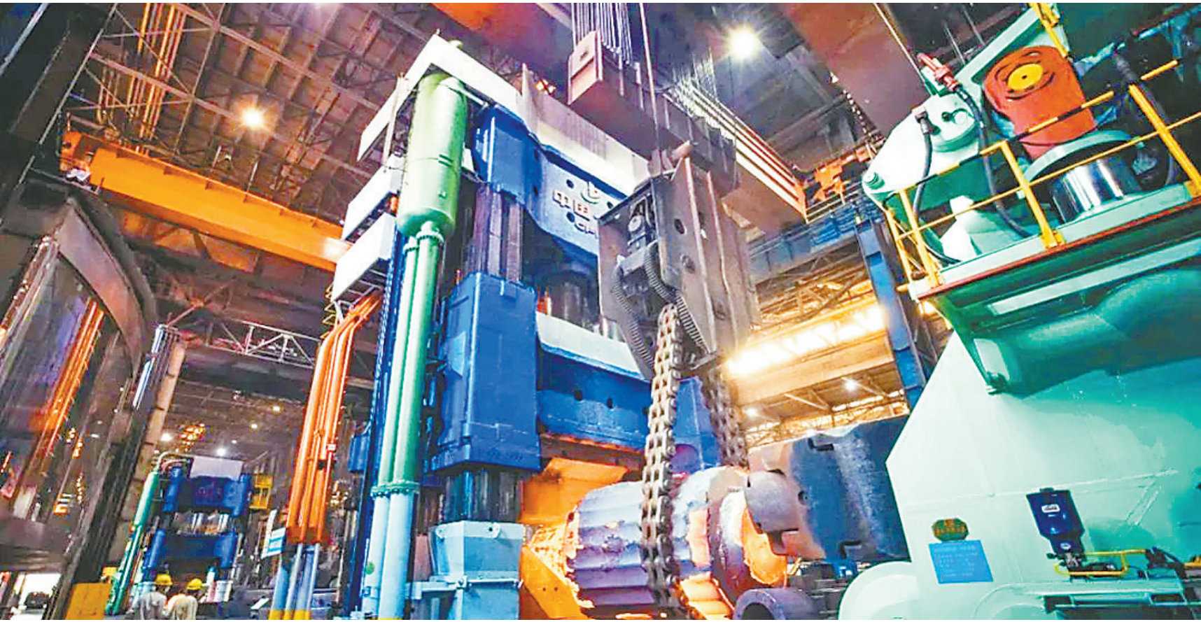
中国一重研发制造的锻造水压机。 一年来,中国一重以创新驱动产业升级,先后攻克700T级钢锭均质化制造、超临界水氧化反应器控制系统、短流程无头轧制生产线高速飞剪设备等25项关键技术,共计开发出高碳马氏体支承辊等9项新产品,以“国之重器”筑牢制造强国根基。
