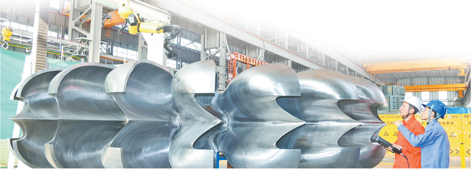
7月2日,凝聚中国水电装备顶尖智慧的全球首台单机容量最大500兆瓦、转轮尺寸最大6.23米的冲击式水轮机核心部件——转轮,在哈电集团哈尔滨电机厂有限责任公司自主研制成功并发运,标志着我国在高水头、大容量冲击式水轮机机组核心装备领域实现历史性突破。
