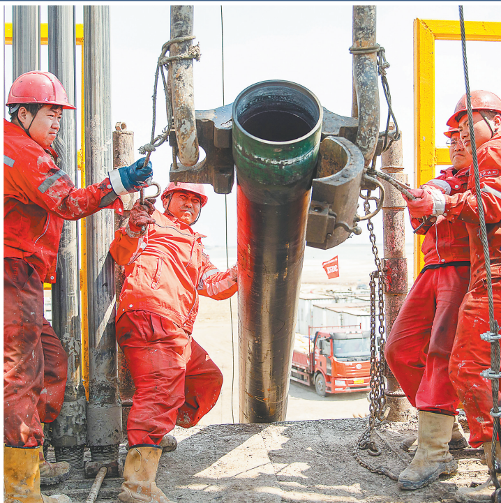
大庆钻探吉林石油工程事业部30572钻井队钻工正在扣表层套管吊卡。刘浩摄
