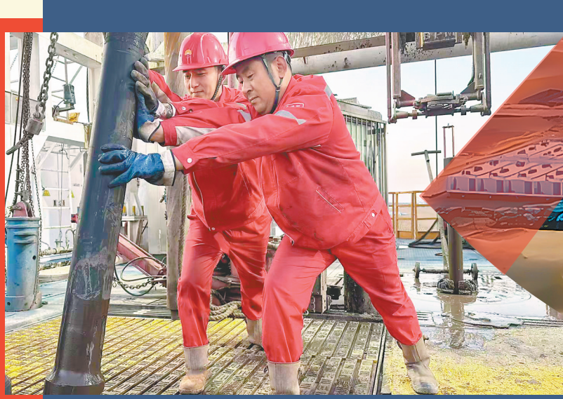
大庆钻探吉林石油工程事业部70375钻井队钻工正在进行起钻作业。刘浩摄
