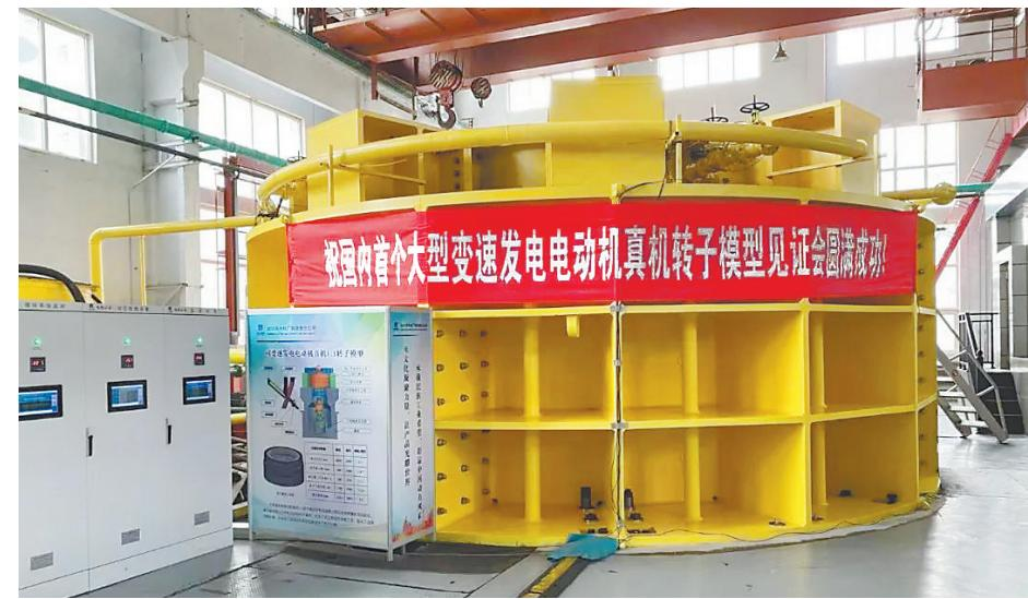
国内首个大型变速发电电动机真机转子模型。
