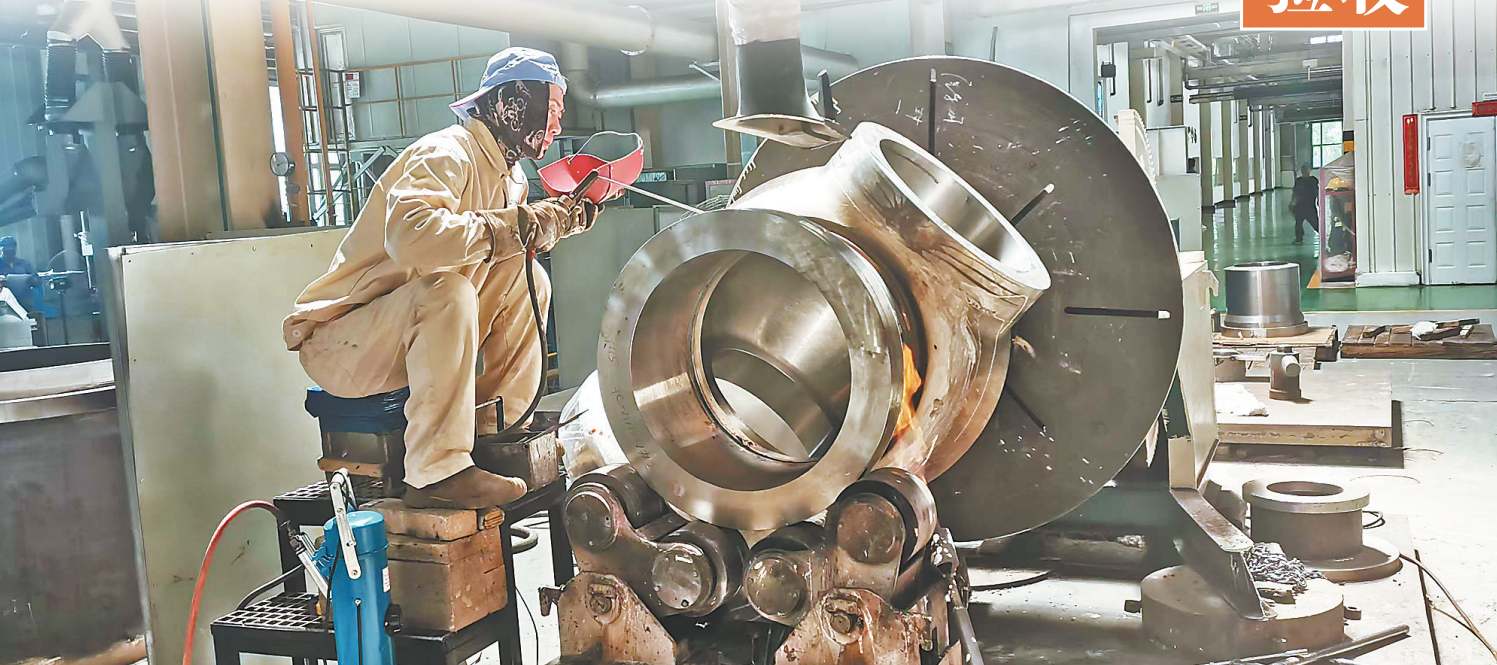
哈电阀门二车间焊接工人正在焊接机组配套旁路阀体。
