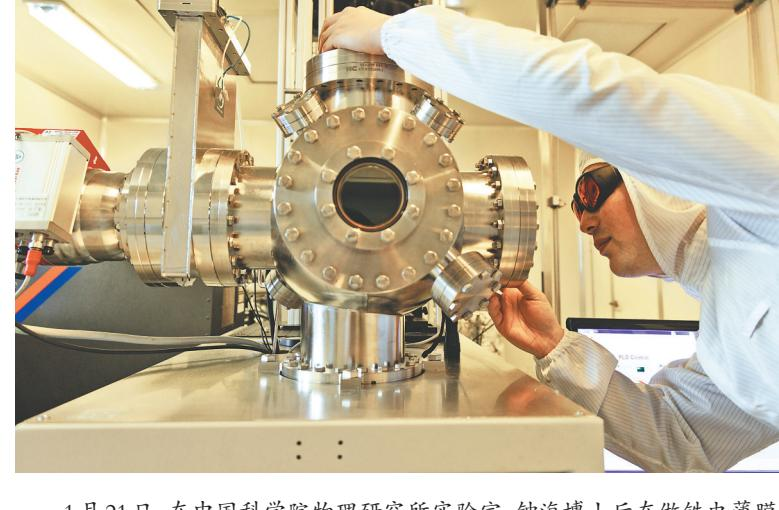
1月21日,在中国科学院物理研究所实验室,钟海博士后在做铁电薄膜沉积实验。
