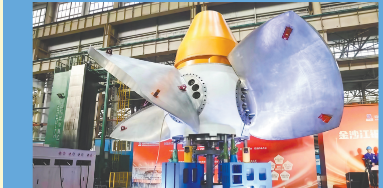
哈工大研制的世纪转轮亚洲最大、转轮直径世界最大的银江机组转轮
