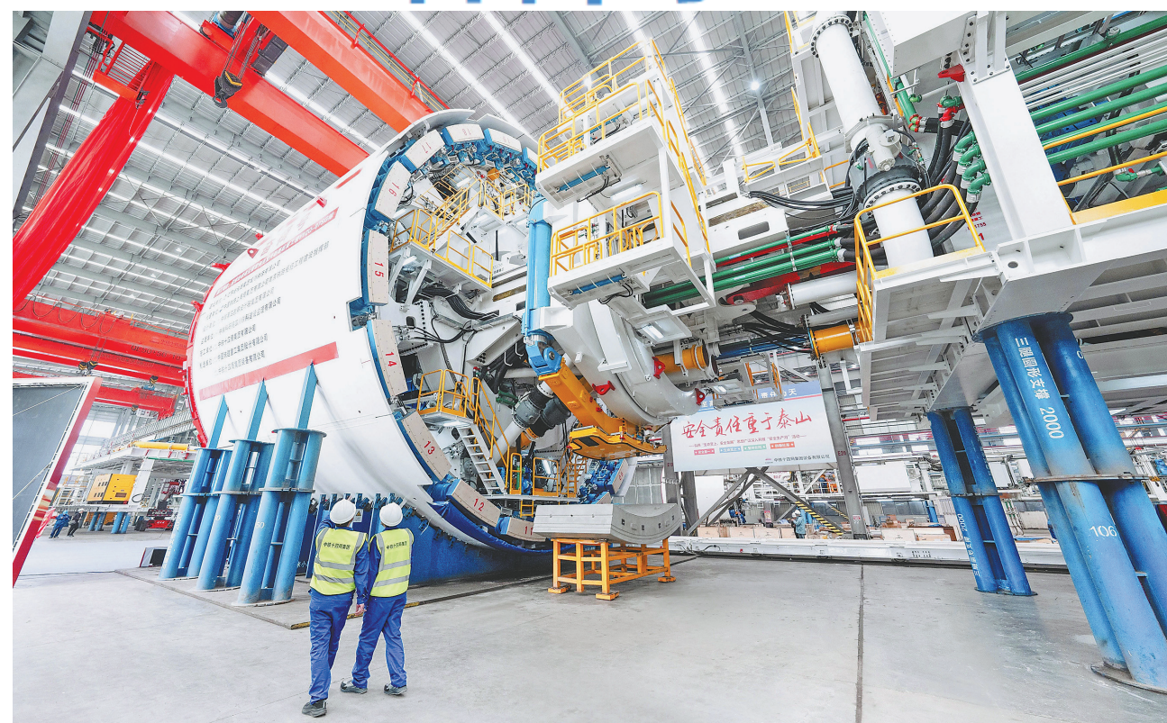
中铁十四局造人员对盾构机整机进行验收。
