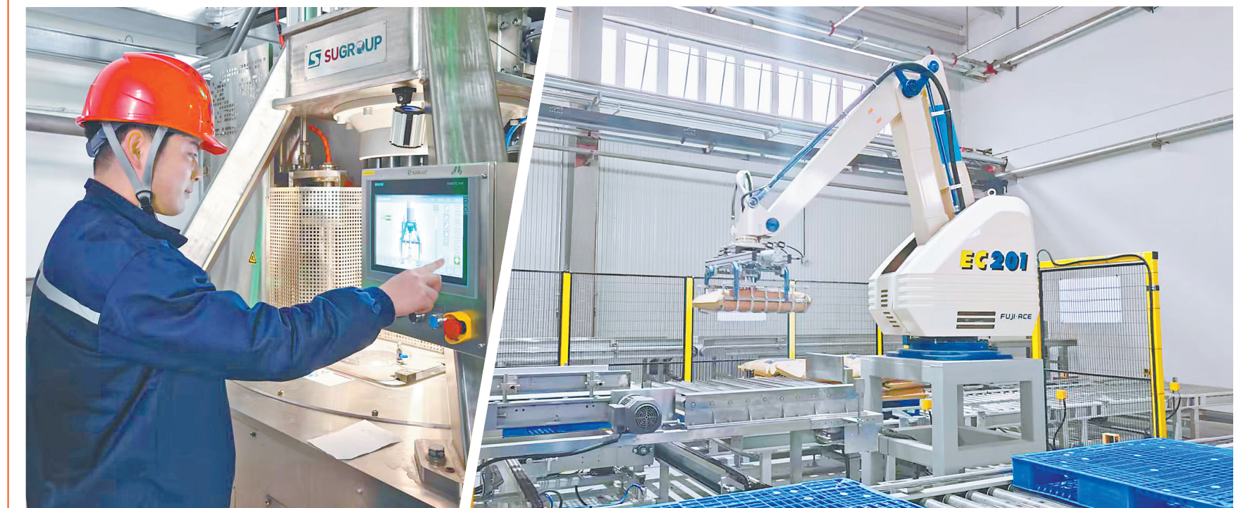
工作人员在进行离心机参数调整。 全自动包装线的码垛手进行码垛作业。
