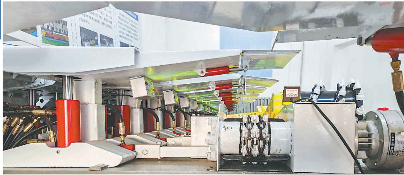
黑龙江科技大学展示的极薄煤层智能开采装备模型。 本报记者 彭溢摄
