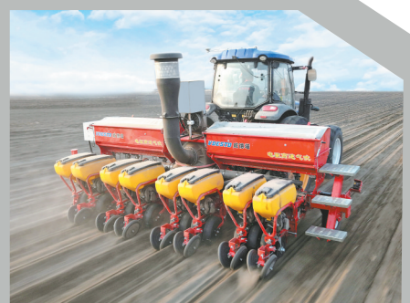
电驱高速气吹播种机。
