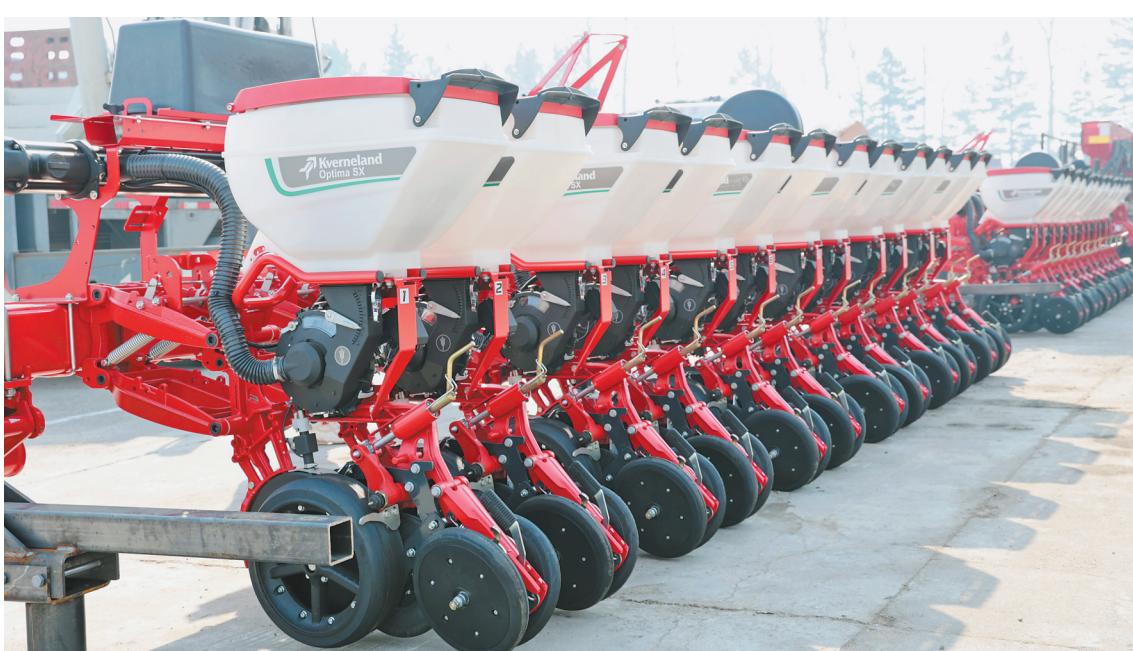
新引进的高速电控气吹式精量播种机。
