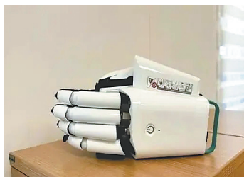
非侵入式脑机接口设备中像手套一样的机械臂。
