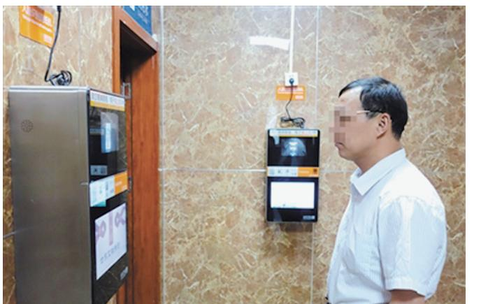
识别厕纸机前,有人在等候取纸。机器上方写着提示:“请您摘掉眼镜、帽子看这里3秒”。记者按照要求站到机器前方正方形黄色的“识别区”,与机器对视3秒,很快出纸口推出了一段近70厘米的厕纸,随后取纸后机器提示:您已取纸,请稍后再来取用。
