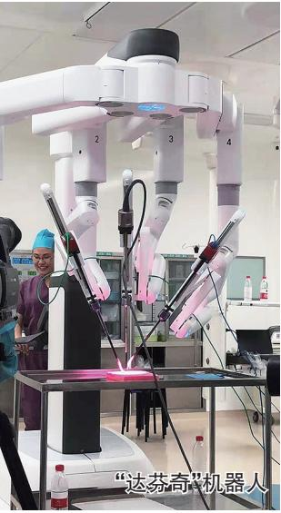
接触患者身体，可直接通过控制板操纵机械臂实施手术。机械臂突破了人手的极限，有7个自由度，使得活动度明显增加，在人手伸不进的区域，机械手可以在360度的空间下灵活穿行，且具有人手无法比拟的稳定性及精确度。而高清晰成像系统通过进入人体内部的特殊镜头，提供可放大15倍的三维高清立体成像，视频速度达到每秒1300次，关照范围也较腹腔镜更大，超越了人眼的极限。
