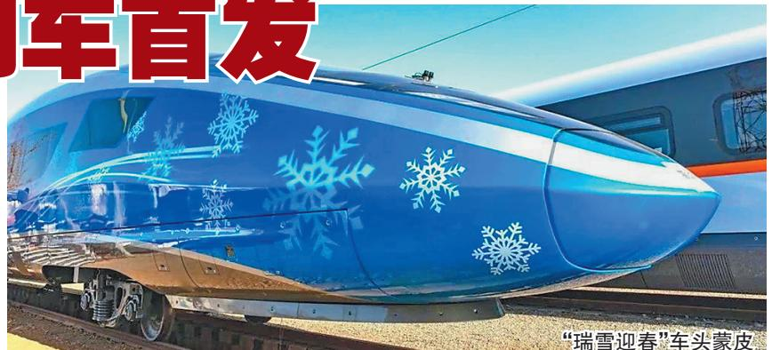
棱。王国峰教授团队采用快速超塑成形工艺，突破以上难点，于2021年6月实现“瑞雪迎春”车头蒙皮的首件检验，将总长为11米的复杂空间曲面成形精度控制在1.5毫米范围之内，并按中车集团厂家设计要求成形出锐棱。近期，已完成“龙凤呈祥”车头蒙皮的首检。
