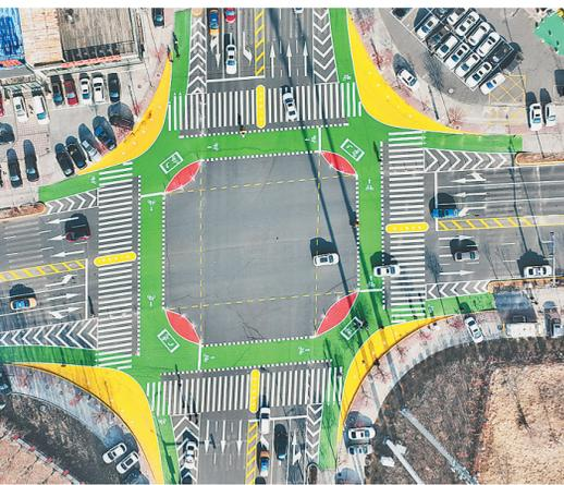
据介绍,黄色区域为行人安全驻足区,施划于交叉口的最外侧,在提高行人安全性的同时,还缩短了行人的过街距离,优化了过街路径;绿色区域为非机动车骑行区,一部分与黄色区域相邻,一部分平行于斑马线,为非机动车提供完整的、单独的骑行绿道,减少与行人、机动车的冲突点;红色区域为转弯危险警示区,施划于交叉口最内侧,表示机动车需要在红色转弯危险区外侧进行右转,不可以提前转弯横穿绿色与黄色区域,为非机动车与行人提供视线与空间的双重保护,独享安全独立的通行空间与时间;黄虚线围合区域为非机动车禁止驶入区,施划于路口中心位置,用以避免左转非机动车在路口内无序行驶的冲突,从而降低安全隐患。
