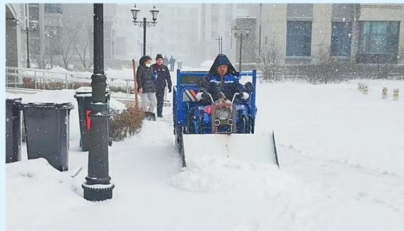
生活报(记者仲亮)将铲车的前斗挂上滚刷成为扫雪车,在三轮车前安装铁板“变身”推雪车……连日来,面对强降雪,冰城各物企为提高清雪效率,纷纷通过对原有机械或车辆进行改造,进一步增加了机械清雪的能力。
