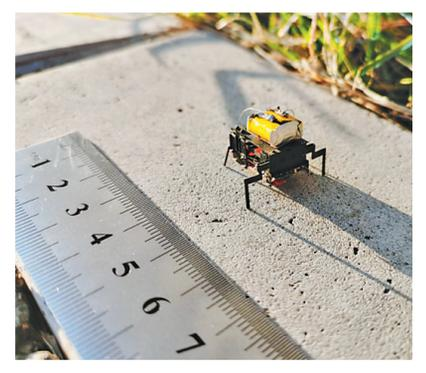
调节,实现高载重下快速爬行;提出基于机器“昆虫”双腿振动频率差的控制方法,实现运动轨迹精确控制。闫晓军表示,这一微型动力技术的成功研发,有望推动微型机器人大范围开发和应用,助力灾后搜救、大型机械设备和基础设施损伤检测等。
