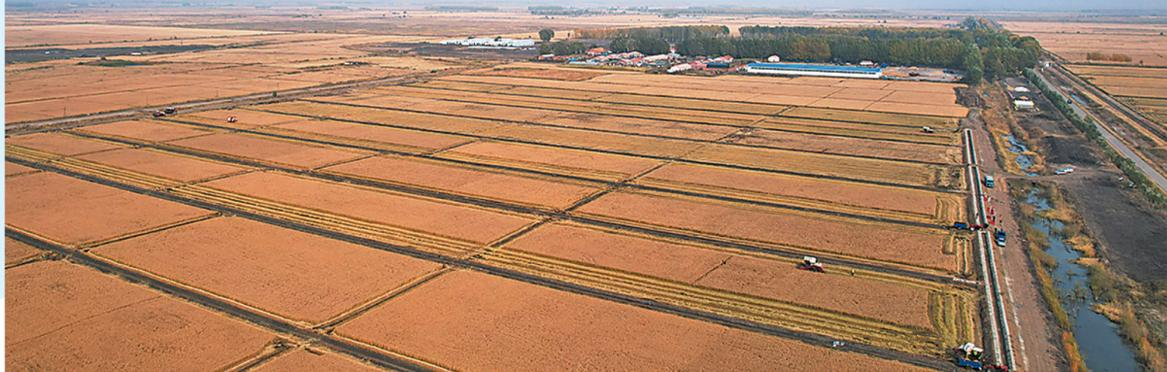
“在实施高标准农田建设前，地块分散零乱，旱不能灌，涝不能排，是典型的低产田。公司帮我们家的格田进行了设计，把原有的小池子改为规整的方格田，变成高标准农田后，干起活来更方便，也节省了成本。”种植户李军说。今年，李军家有600亩水田进行了标准化格田改造，改造后地块减少了池埂和水渠的占地面积，土地平整度和土地利用率均得到提升，既减少了田间工程，还使插植面积增加了4%左右。同时，节水控制灌溉技术优势得到有效发挥，亩节水100立方米以上，作业效率平均提高15%，低洼地变成平整地、小池子变成大格田、低产田变成高产田，综合亩增效135元至165元。
