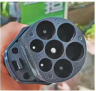
充电桩插头与电动自行车插座规格明显不符
